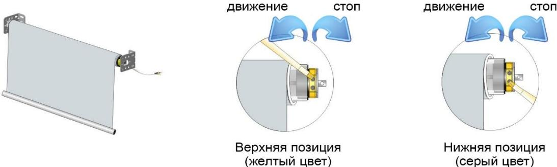
**B. Внутренняя намотка на вал, мотор с правой стороны** (на рисунке стрелкой показано направление движения: против часовой - движение оконечной планки, по часовой - остановка планки)\*
